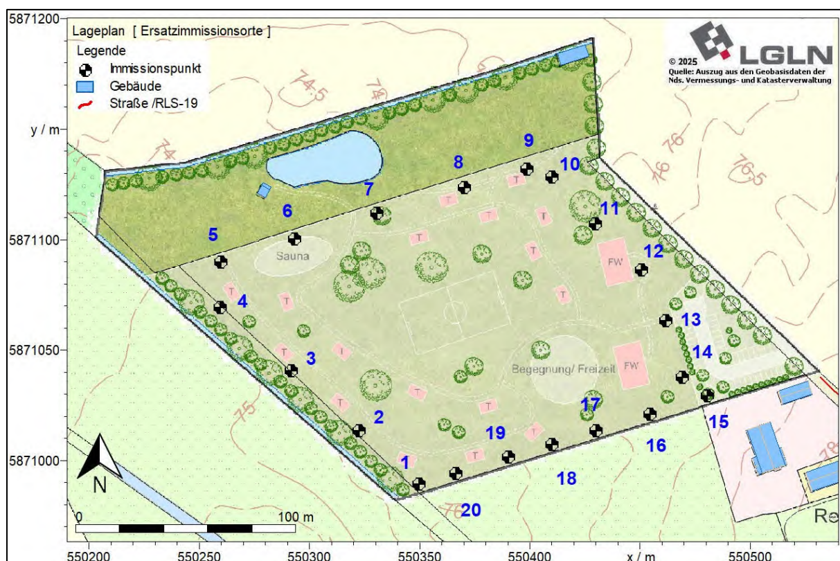
Abb. 7: Ersatzimmissionsorte auf Höhe des 1. Obergeschosses.
