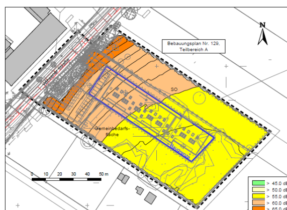
Abbildung 7: maßgeblicher Außenlärmpegel für schutzbedürftige Räume, die überwiegend zum Schlafen genutzt werden, Abbildung 2; Quelle: schalltechnische Untersuchung LairmConsult
