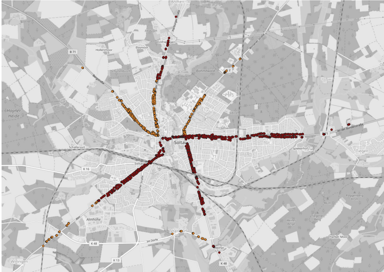
Abbildung 9: Detailkarte der Kernstadt von Soltau mit den markierten Fassaden mit Überschreitungen der Auslösewerte. Rot = gemäß EU-Pflicht-Angaben. Orange = zusätzliche Fassadenpunkte gemäß END+-Kartierung
