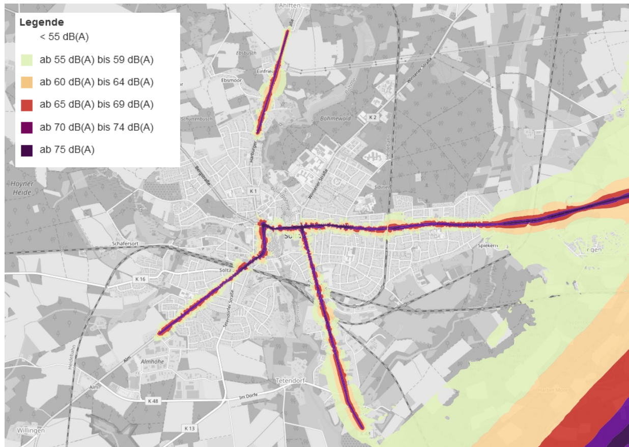
Abbildung 5: Detailansicht der Lärmkarte L_{den} mit der durch Lärm belasteten Bebauung in der Kernstadt Soltau gemäß EU-Pflicht
