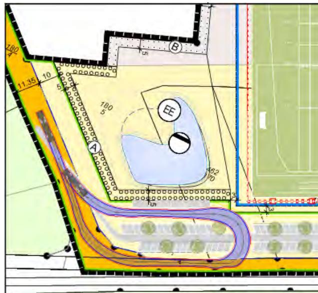
**Abbildung 6:** Schleppkurvenprüfung Linienbus 15,00 m; H&P Ingenieure GmbH, Soltau (ohne Maßstab).
