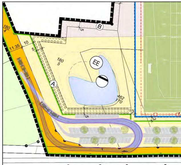
Abbildung 7: Schleppkurvenprüfung Lastzug mit Anhänger 17,19 m; H&P Ingenieure GmbH, Soltau (ohne Maßstab).
