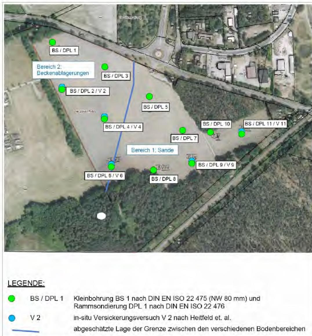
Abbildung 9: Lageplan Baugrundbeurteilung. Quelle: Baugrunduntersuchung Michael Beuße mbH, 2019.
