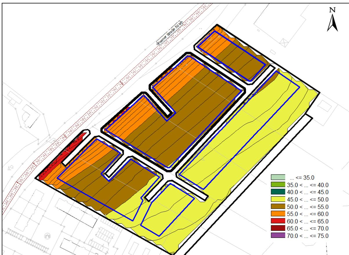
Abbildung 5 Immissionsraster nachts h=5m, freie Schallausbreitung für das geplante WA
